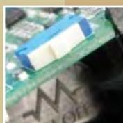
**Microinterruptor "On/Off" para la resistencia**
